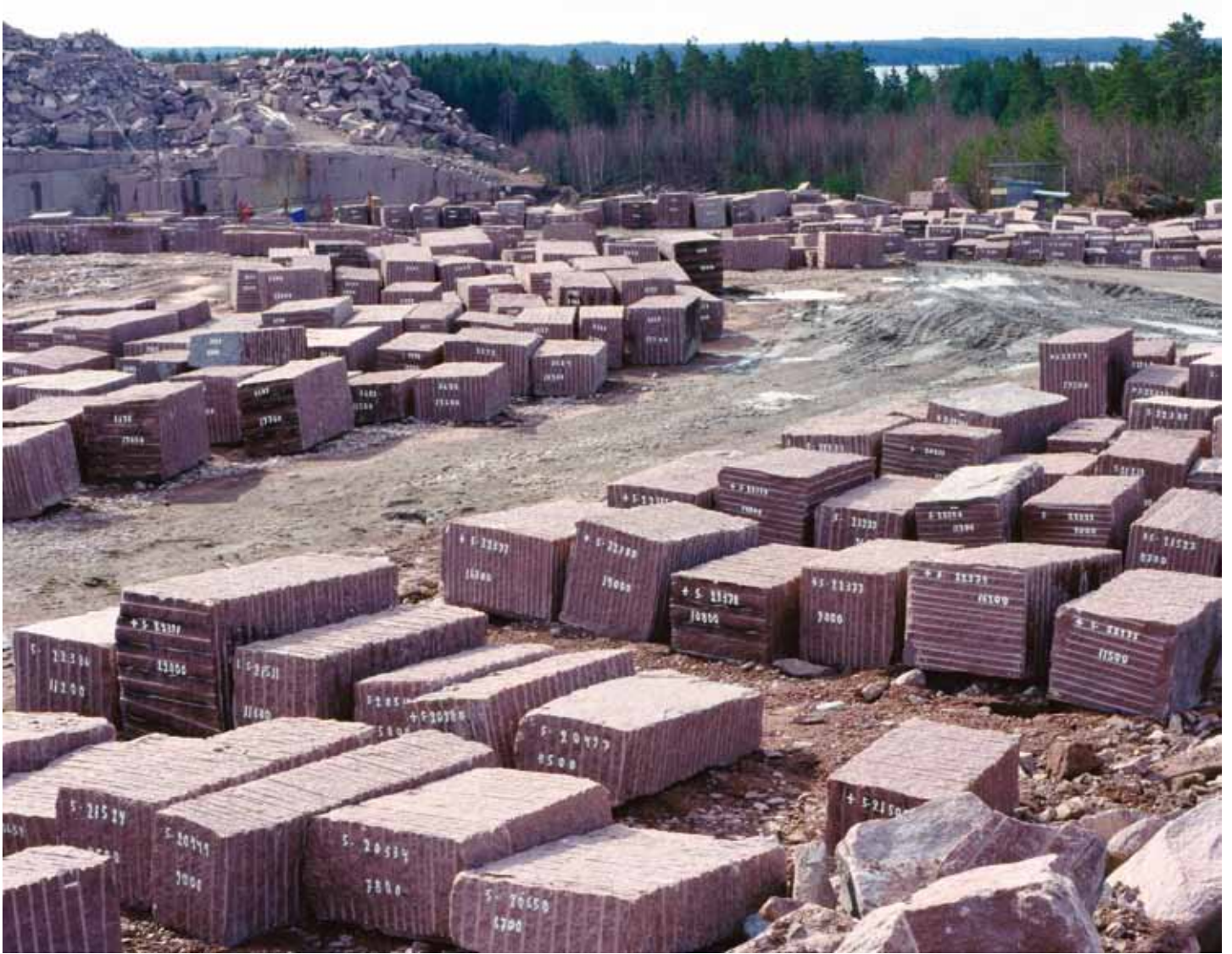
Kuva 9. Riittävän ehjästä luonnonkiviesiintymästä saadaan suuria blokkeja. Kuva: Palin Granit Oy.
